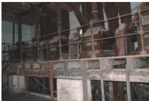
Pulsano (TA). Molino a cilindri Scoppetta: laminatoi e buratti.
