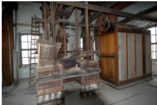
Pulsano (TA). Molino a cilindri Scoppetta: laminatoi e buratti.
